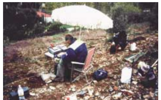
Fotografía 2: Ejecución del Sondeo Eléctrico Vertical
